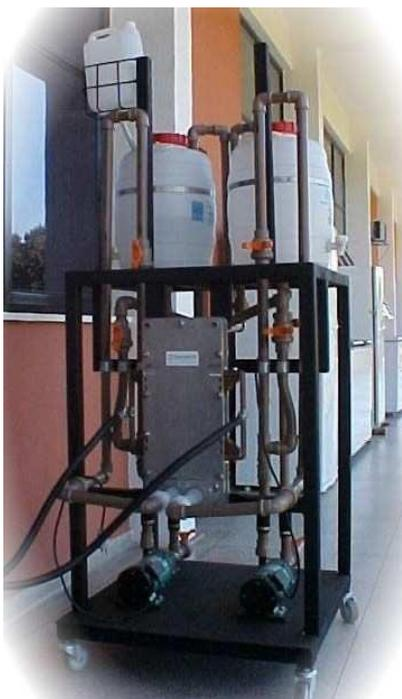
*Reator eletroquímico e periféricos utilizado para tratamento de efluentes industriais. Área do eletrodo: 0,8 m<sup>2</sup>. Vazão máxima: 16 L min<sup>-1</sup>.*
